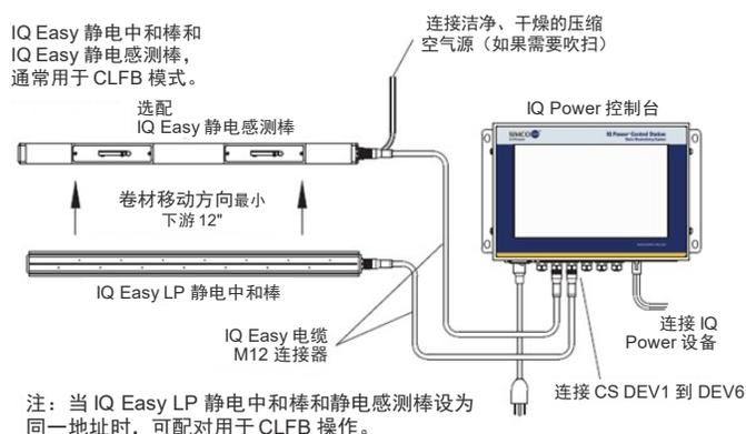
高输出功率的特性意味着, IQ Easy LP 静电中和棒能够在广泛的各类应用中实现尽可能低的残余电荷。
