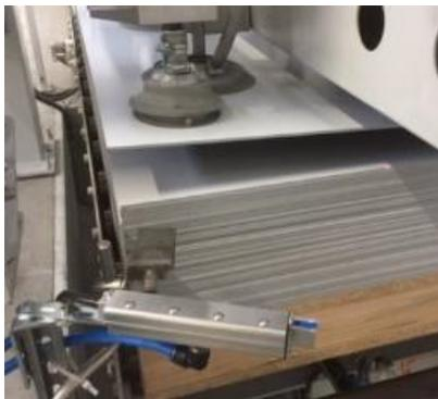
在印刷品卸垛过程中，单张印刷品会因为静电而粘附在印刷品堆上；使用（扁平）离子风嘴或 [带静电消除棒的风刀](#) 在印刷品之间进行电离吹风，可帮助解决该问题，确保只有单张静电中性状态的印刷品进入生产线。
